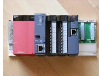
Fig.3. Mitsubishi PLC (Q03UDV CPU)
